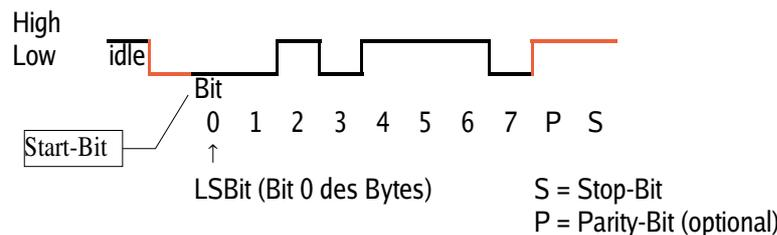
Flanke dient zur Synchronisation, Abtastung in der Bit-Mitte (typischerweise bis zu drei Abtastungen).
