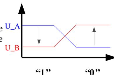
Der RS485-Standard wird auch vom SIEMENS-Profibus verwendet
